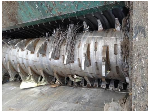
Bild: Walze nach der Entfernung durch die automatische Kammpositionierung
